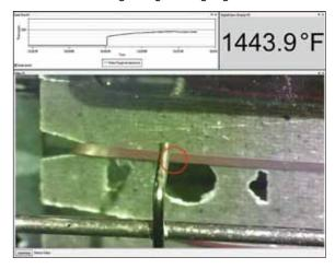
anderen Methoden nicht zugänglich wären. Der über ein flexibles Glasfaserkabel von der Elektronikbox getrennte optische Sensor kann in Nähe des Messobjekts positioniert werden, während die Elektronik in sicherer Entfernung an einem passenden Ort installiert wird.
