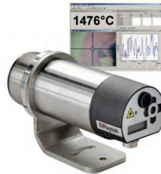
Abb. 18: Pyrometer mit einstellbarem Scharfpunkt (Raytek MM Serie mit variablem Fokus). Als Visiereinrichtung kommt u.a. eine Videokamera zum Einsatz, welche bei Veränderung der Messentfernung den Messfleck immer korrekt darstellt.
