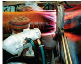
Abb. 9: Genaue Temperaturmessungen an Brammen, Walzblöcken oder Rohren gewährleisten eine einheitliche Produktqualität
