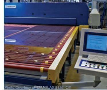
Abb. 13: Die durchgängige Temperaturüberwachung von der Glasschmelze bis zum Endprodukt gewährleistet die geforderten Produkteigenschaften, hier beim Vorspannen von Glasscheiben
