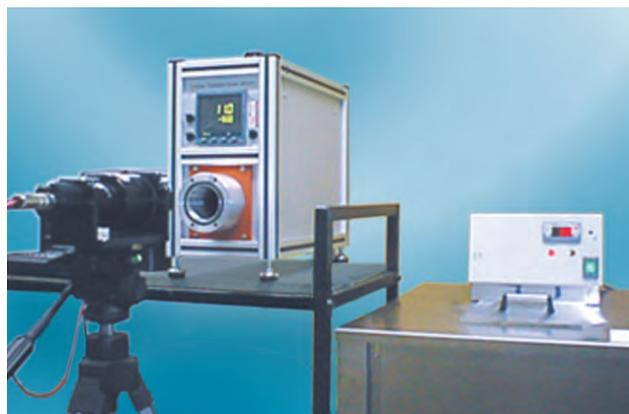
Abb. 24: Kalibrierung eines Schwarzstrahlers mittels TRIRAT LT Transferrnormal der Firma Raytek
