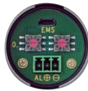
Thermalert 4.0 in Zweidraht-Ausführung mit Anschlussklemme für die Stromversorgung und den analogen Ausgang
