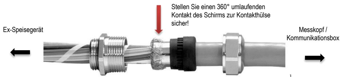
Abbildung 45: EMV gerechter Anschluss eines Kabels für Messköpfe und Kommunikationsbox
