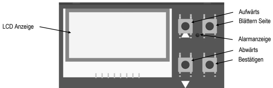
Abbildung 34: Bedienelemente der Kommunikationsbox (DIN)
