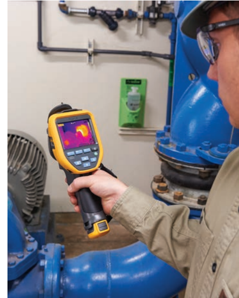
Ein Techniker inspiziert einen Motor mit einer Wärmebildkamera Fluke TiS75
